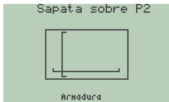
Figura 88 - Viga alavanca - Detalhamento das armaduras da sapata sobre P2.
