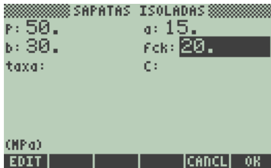
Figura 16 – Sapata isolada - Tela de entrada de dados – fck.
