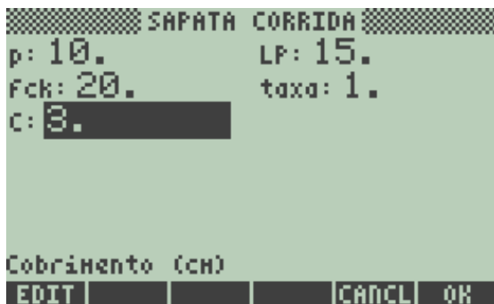
Figura 71 - Sapata corrida sem viga de rigidez - Tela de entrada de dados.
