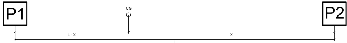
Figura 2 - Situação entre pilares para dimensionamento de sapatas associadas.
