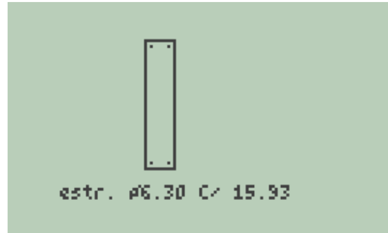
Figura 63 - Sapata corrida com viga de rigidez - Detalhamento dos estribos.
