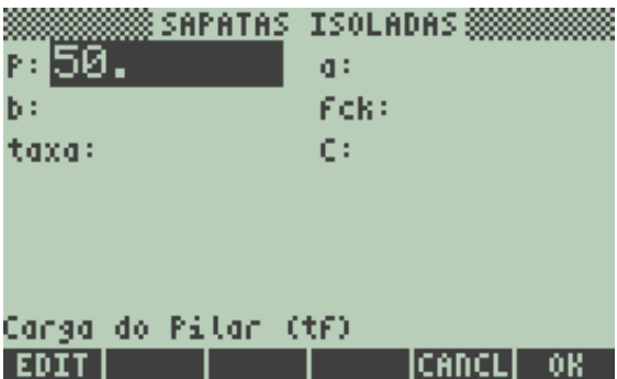
Figura 13 - Sapata isolada - Tela de entrada de dados - Carga.
