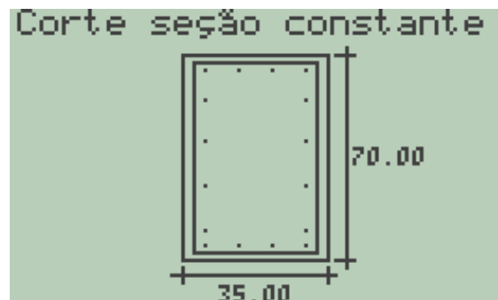
Figura 94 - Viga alavanca - Detalhamento da seção transversal.
