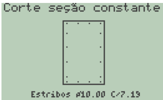
Figura 93 - Viga alavanca - Detalhamento dos estribos.
