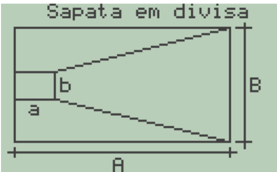
Figura 100 - Sapata em divisa - Esquema inicial para identificação dos lançamentos de dados.
