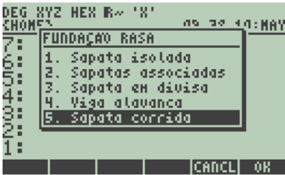
Figura 58 - Sapata corrida - Tela inicial do programa: seleção sapata corrida .
