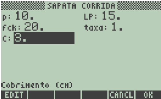
Figura 60 - Sapata corrida com viga de rigidez - Tela de entrada de dados.
