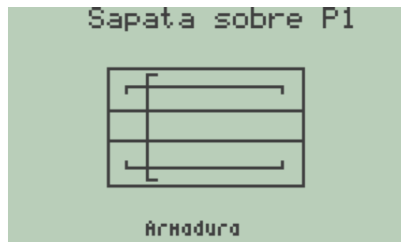
Figura 86 - Viga alavanca - Detalhamento das armaduras da sapata sobre P1.
