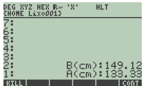
Figura 21 - Sapata isolada - Tela de saída de dados - dimensão A.
